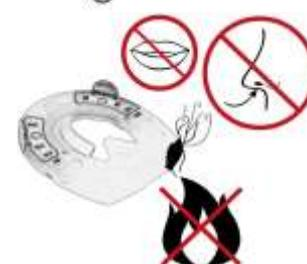
La buse de réduction avec l'embout spécial ainsi que la plaque de soudage sont également chauffées en conséquence pendant les travaux de soudage, ce qui entraîne un risque de brûlure de la peau.
