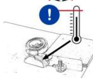
Laissez le dispositif de soudage refroidir suffisamment avant de le démonter.
