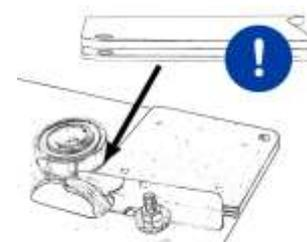
Avant de mettre l'appareil à air chaud en marche, vérifiez que la buse de réduction oriente le flux d'air dans la bonne direction.
