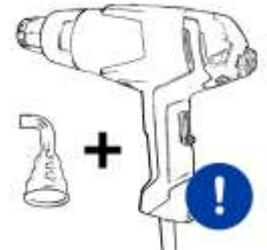
**PRECAUCIÓN** El secador de aire caliente debe estar apagado y, preferiblemente, desconectado antes de montar la boquilla reductora.
