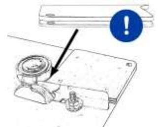
Prima di accendere il dispositivo ad aria calda, verificare che l'ugello riduttore indirizzi correttamente il flusso d'aria.
