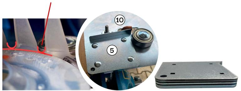
IV. Sitúe la boquilla (n° 4) en su pistola de aire caliente (vea n° 4). Posicione la pistola en el dispositivo de fijación de la placa de soldadura (n° 10). Utilice la llave de dos bocas de 10mm (n° 3) para manualmente apretar la pistola.
