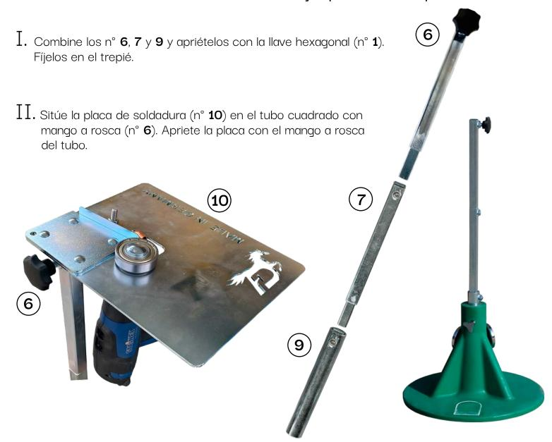
III. Sitúe los espaciadores apropiados (n° 5) en los hoyos de la placa de soldadura (n° 10) y fíjelos con los tornillos. Necesita espaciadores diferentes según la herradura o las lengüetas de pegar. Seleccione los espaciadores de modo que el punto más bajo del redondeo semicircular entre las lengüetas quede enrasado con el borde superior de la herradura.
