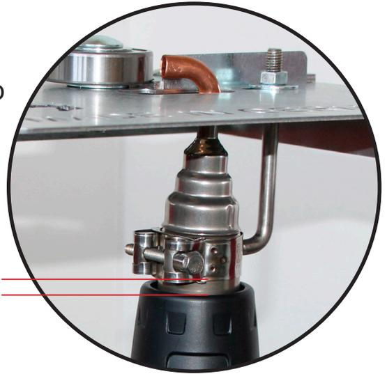
Puede también cambiar la posición de la pistola de aire caliente en la superficie de la placa de soldadura. Utilice la llave de boca (nº 2) para aflojar la tuerca. Reposicione la pistola de aire caliente en el hoyo y manualmente reapriete la tuerca.
